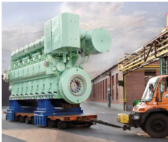
Figur 6. 4-taktsmotor avsedd för framdrift, effekt ca 8500 kW.
