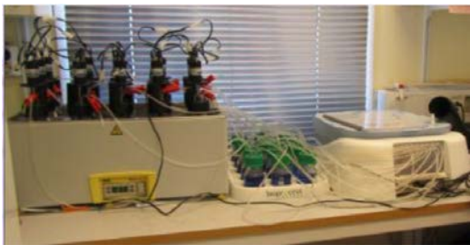
Figur 4. Bild över Bioprocess Control och utrustningen som användes för rötning (Shi 2012).
