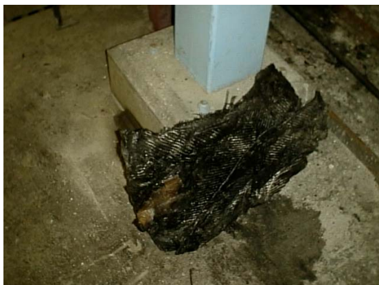
En förkolnad bit tagen från askutmatningen från en sopförbränningsanläggning [6]. Biten som är helt organiskt har inte förbränts p g a sin storlek. Stålpelaren bakom den oförbrända klumpen är ca 20 cm bred.
