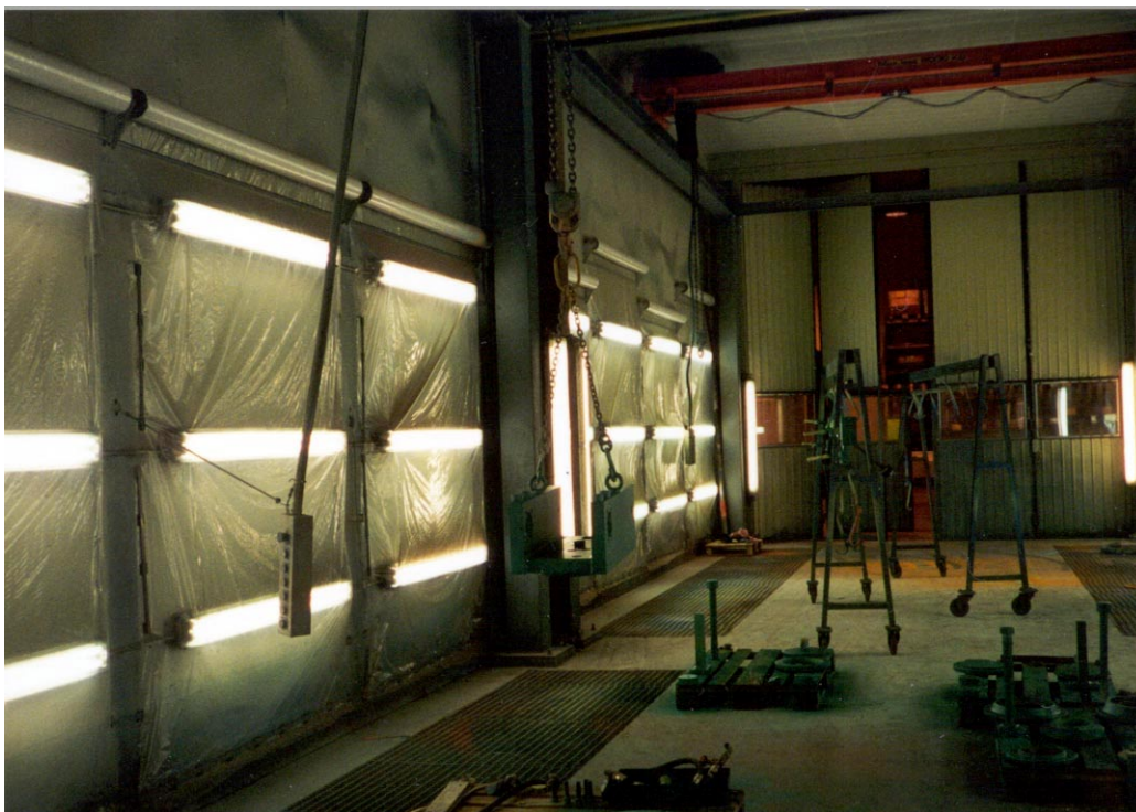
Bild 1. Plastfilmen över lysrören byts ut när sprutlackering genomförs. Det leder till bättre belysning och mindre spill av städkemikalier.
