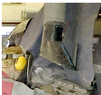
Bild 3. Punktutsug. På bilden är utsuget placerat ovanför svetsstället.
