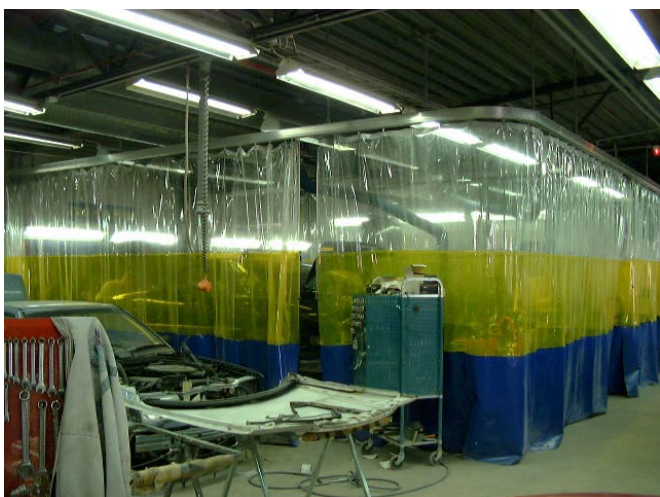
Bild 15. Övre raden vänster. Aluminiumramade genomsynliga plastväggar med nerrullningsbar öppning.
