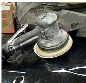
Bild 4. Integrerat utsug. Oscillerande slipmaskin med integrerat utsug.
