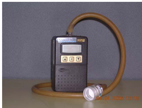
Figur 2. Pump och filtermonitor för filterprovtagning.
