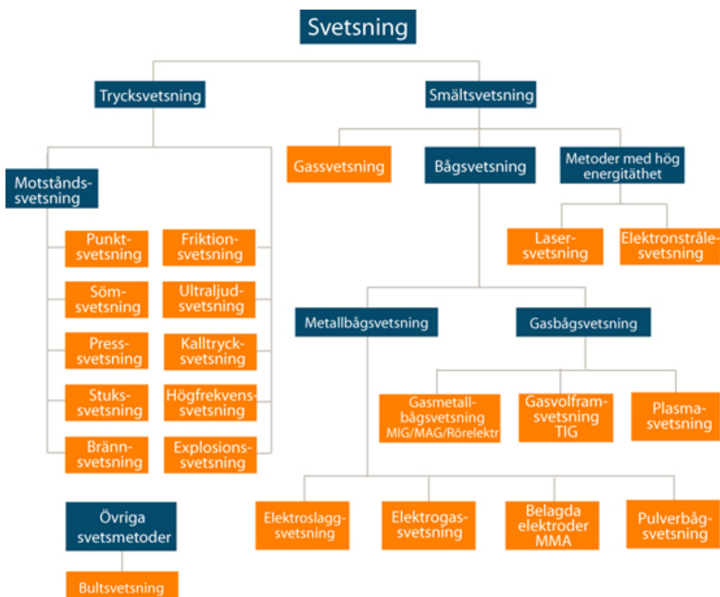
Figur 1. Beskrivning av indelningen av svetsmetoder. Tillgänglig på http://www.svets.se/tekniskinfo/svetsning/metoder.4.ec944110677af1e8380009688.html Svetskommissionen (2006-04-04)
