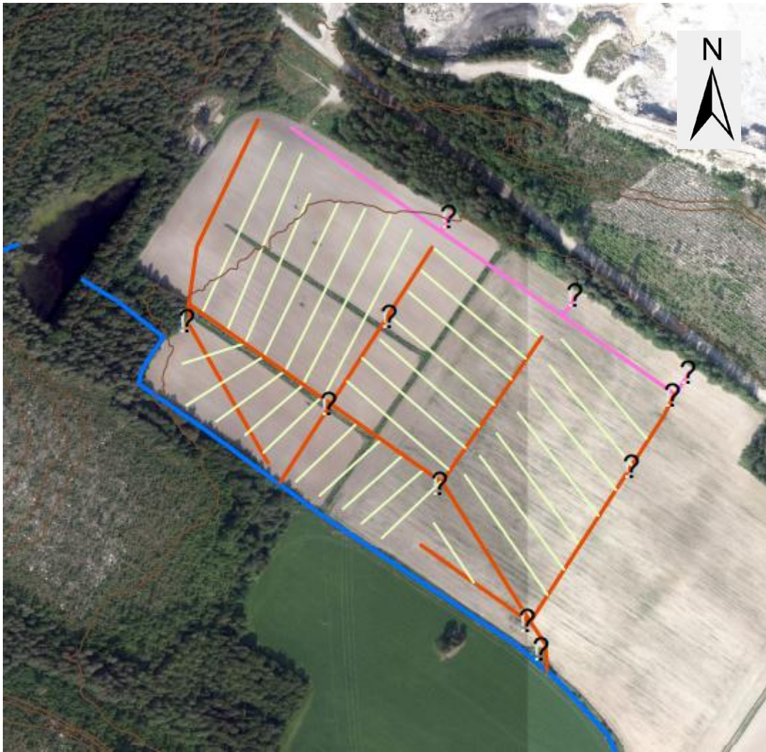
Figur 4. Exempel på ett täckdikningssystem på Öjebyn Agro Park. Gula linjer är grenledningar ("sugare"), bruna är stamledningar, och blåa utgör huvudavlopp (dike). Den osäkra funktionen indikeras av frågetecknen.
