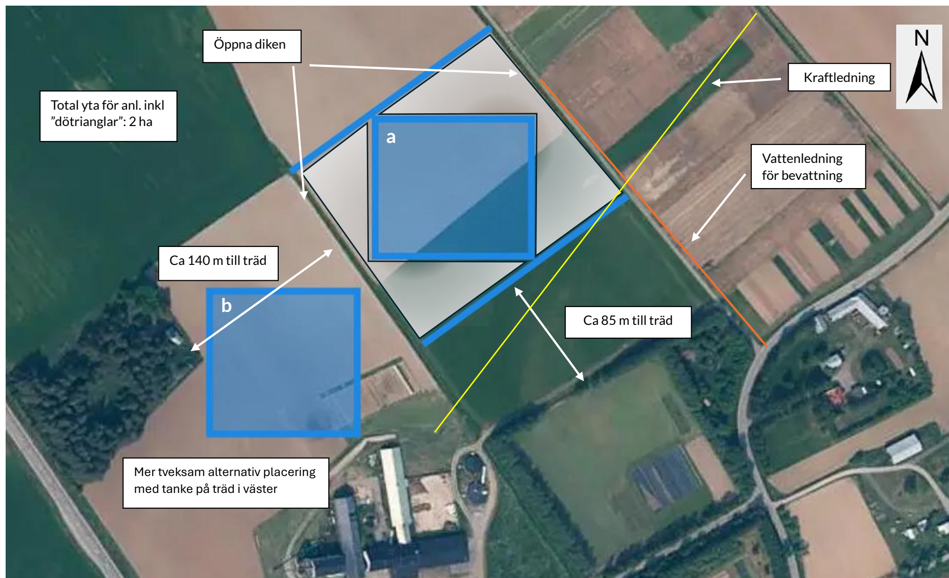
Figur 5. Förevisning av en ur flera perspektiv lämplig placering för en 1 hektar stor yta för solsambruk och referensodling (a) och dess markanspråk, samt en möjlig men mindre lämplig placering (b) på grund av skugga. Gul linje markerar en kraftledning med stolpar i närheten och orange linje är en vattenledning längs med en körväg som möjliggör bevattning och access till området.
