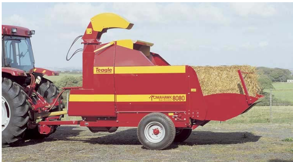
Figur 5. Bogserad traktordriven balsnittare, Tomahawk 8080 DC med hydraulisk manövrerad bakre lastlucka. Källa: www.trejon.se
