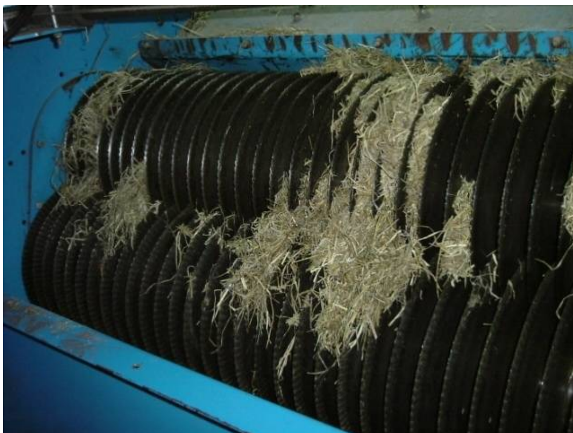
Figur 7. Valmetal, stationär eldriven balrivare för rund- och fyrkantbalar. Källa: www.neuero.se
