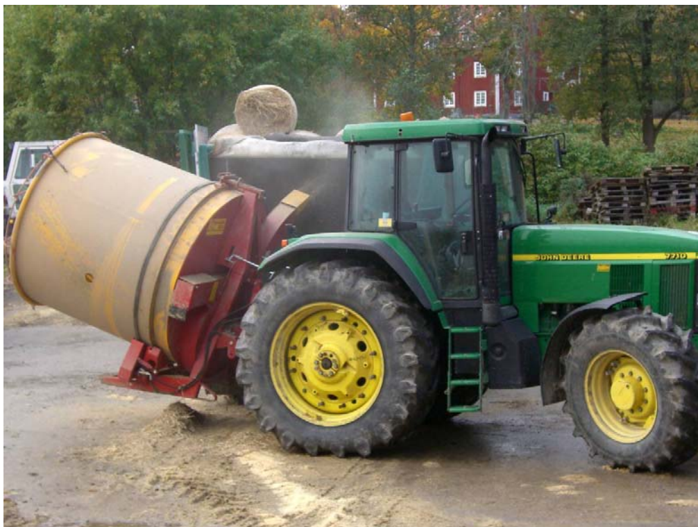
Figur 11. Balsnittare Tomahawk 505 M för snittning av rörlensbalar på Låtra Gård.
