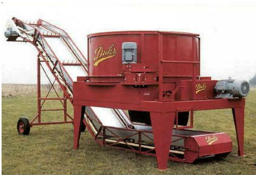
Figur 6. Duks, stationär eldriven balsnittare för rundbalar. Källa: www.Duksmaskiner.se
