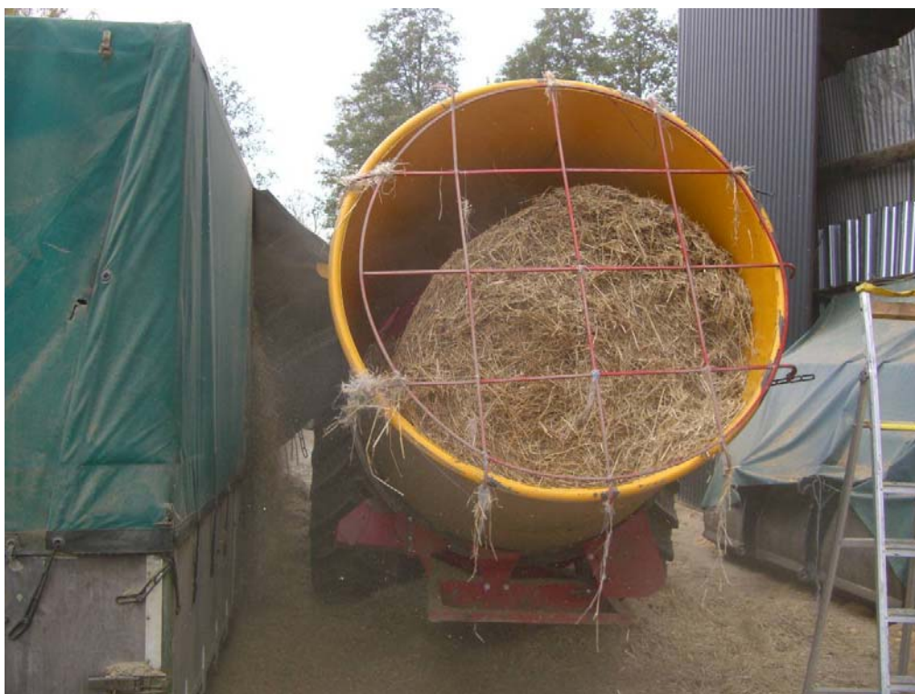
Figur 12. Balsnittare Tomahawk 505 M för snittning av rörlensbalar på Låtra Gård.
