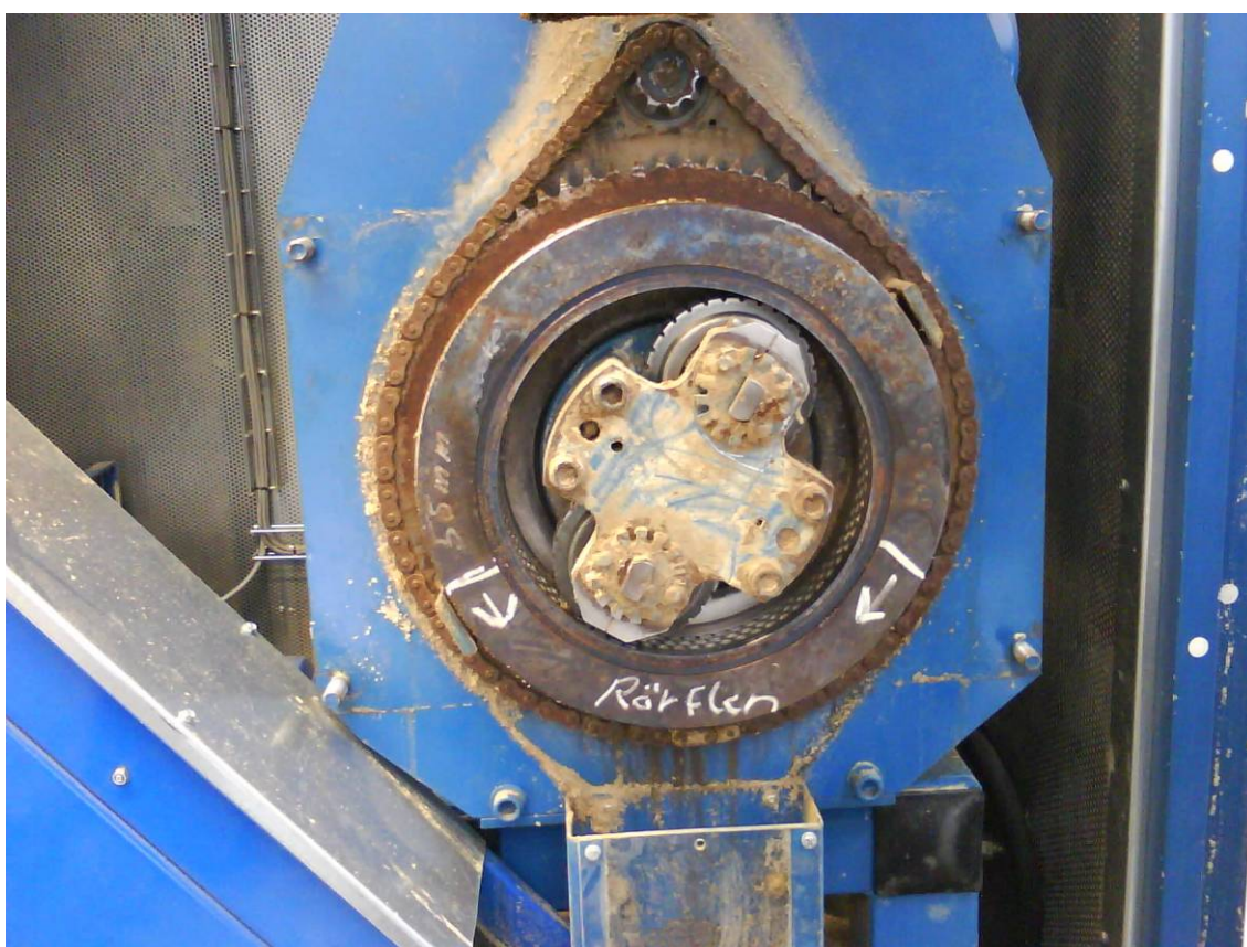
Figur 1. Principen för en SPC-pelletspress med två rörliga pressrullar och en fast matris.
