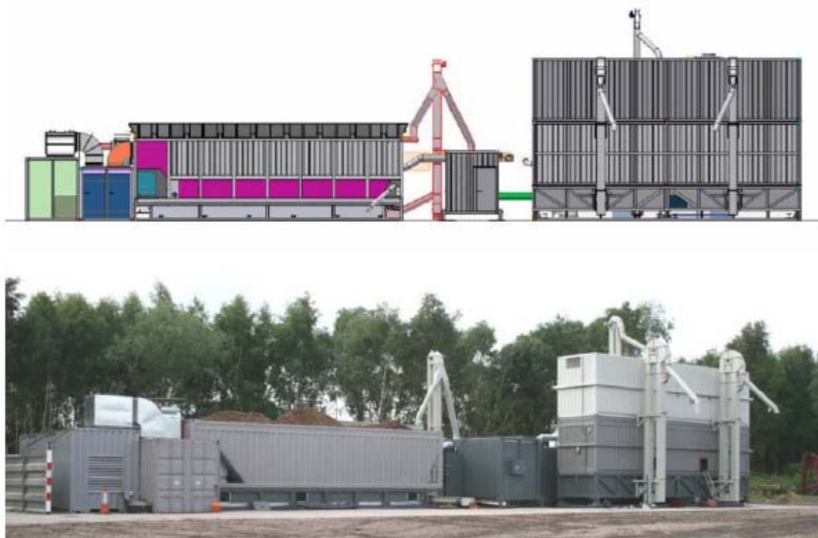
Figur 15. Mobil pelleteringsanläggning för jordbruksgrödor och skogsbränsle i Retford England. Produktionskapacitet 10 000 ton pellets/år. Källa Biojoule, 2007.
