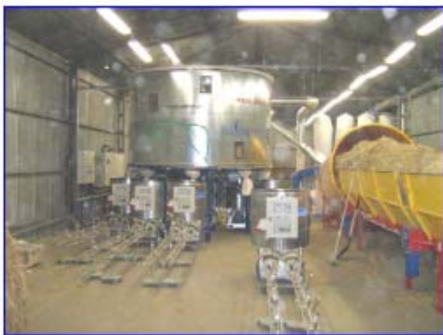
Figur 6. Kompletta kedja för brikettering av halm i Polen. Källa (Asket, 2008).
