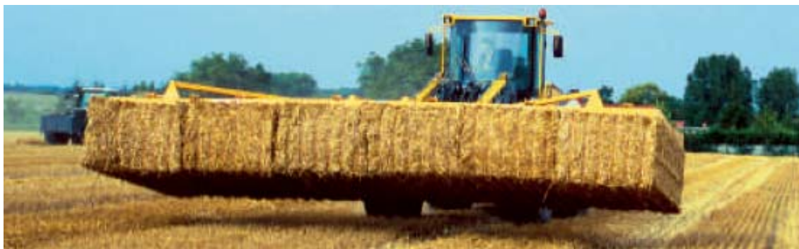
Figur 7. Exempel på teknik som kan skapa moduler av flera balar tidigt i kedjan. Källa (Krone, 2008).
