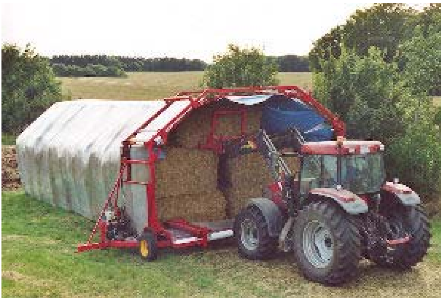
Figur 9. Lagring av halm i plasttunnel med en PomiWrap 5 ( www.pajse.se ).
