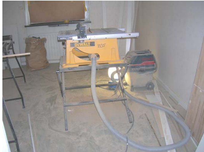
Bild 21. Cirkelsåg med dåligt underhållet utsug. Ljuset från lampan reflekteras i dammet, vilket gör att bilden ser grå ut.
