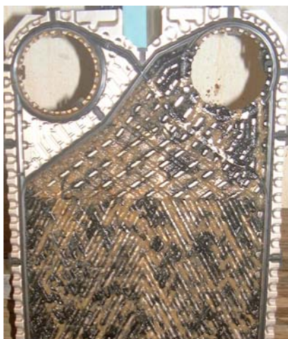
b) Plattor direkt efter isärtagandet.
