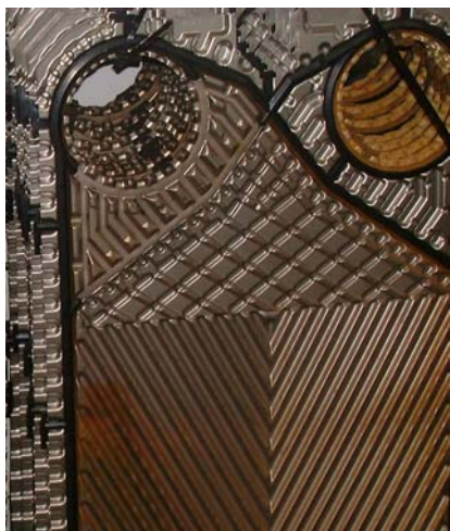
a) Rena plattor innan montering i växlaren.
