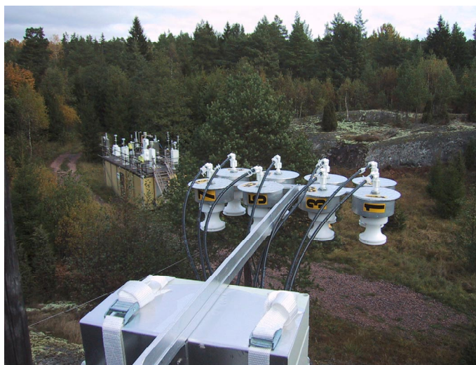
Figur 3. PM_{10} mätningar i Aspvreten. På bilden syns IVLs provtagare med veckoautomat.
