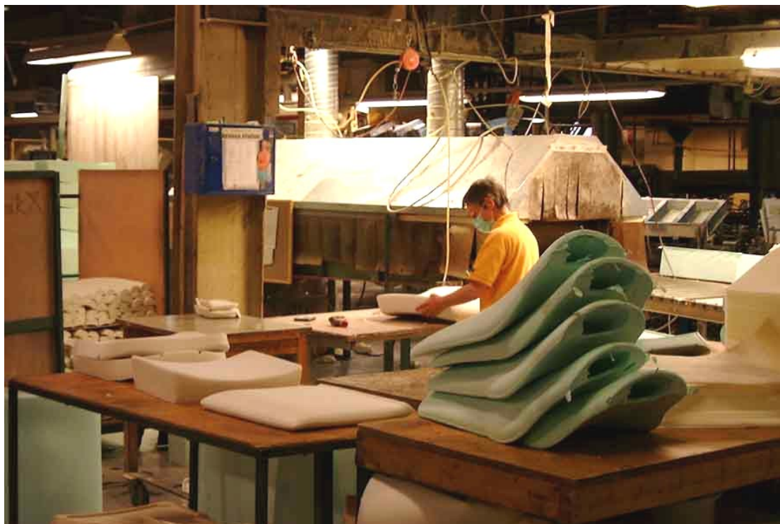
Bild 4 Transportbandet ledde in i en ventilerad tunnel. Bilden visar putsning som skedda efter passagen genom tunneln.
