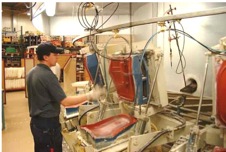
Bild 3 Gjutformar sprayas med släppmedel
